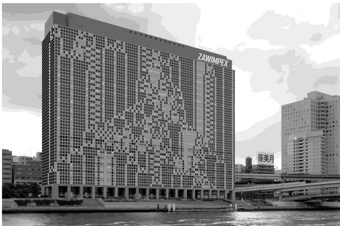
42. Wizualizacja systemu zaciemniania elewacji przez modułarny system oparty o jednowymiarowy automat komórkowy zakresu-2 o kodzie {3818817080, 2, 2} na siatce kwadratowej.
