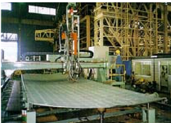
Rys. 35. Japoński system IHI-Alpha do automatycznego termicznego kształtowania blach poszycia statku [http://www.ihl.co.jp].
