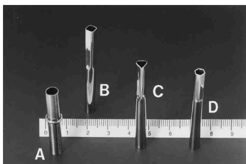
Rys. 28. Kształtowanie żeber i zmiana kształtu przekroju rurek ze stali nierdzewnej: A – średnica 6 mm, gr. 0.5 mm; B, C, D – średnica 5 mm, gr. 0.35 mm.
