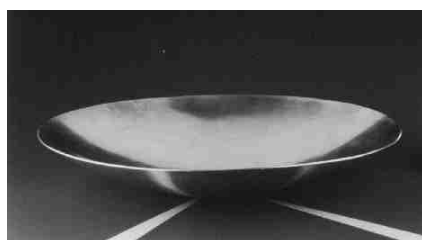
Rys. 23. Powierzchnia sferyczna ukształtowana laserowo z płaskiej blachy [Frąckiewicz 1993].
