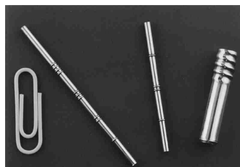
Rys. 29. Kształtowanie żeber i wykonywanie gwintów na małych rurkach ze stali nierdzewnej: A, B – średnica 2 mm, gr. 0.25 mm; C – średnica 6 mm, gr. 0.5 mm.
