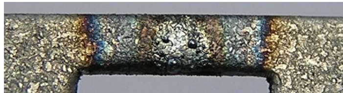
Rys. 91: Barwy nalotowe na segmencie 1 aktuatora wykonanego ze stali niskowęglowej.
