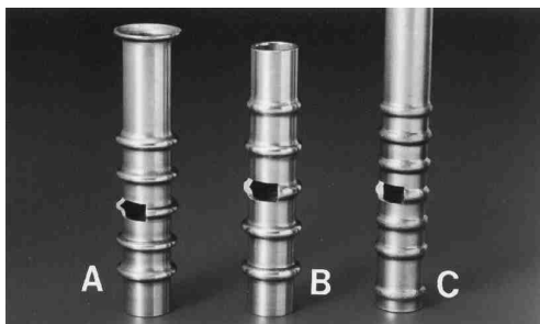
Rys. 26. Kształtowanie żeber na rurach z kontrolowaniem grubości ścianki (średnica 20 mm, tytan).
