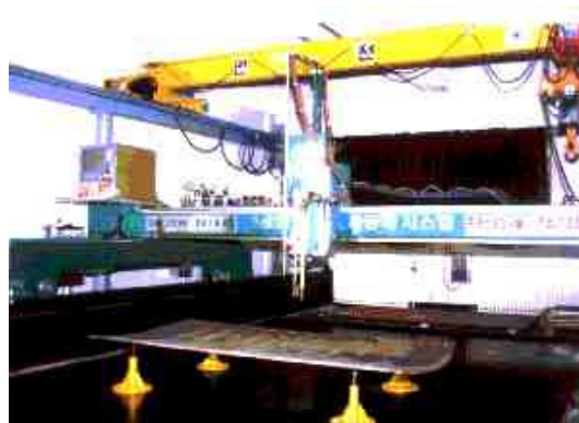
Rys. 34. Stanowisko iCALM do automatycznego termicznego kształtowania blach poszycia statku. Wymiary: dł. 6m, szer. 4.2 m, wys. 2 m.
