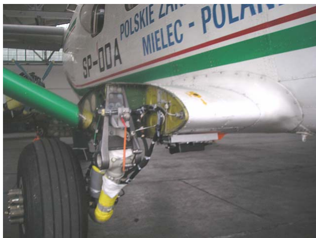
Rys.1.7. Widok ogólny adaptacyjnego absorbera podwozia samolotu M28 Skytruck
