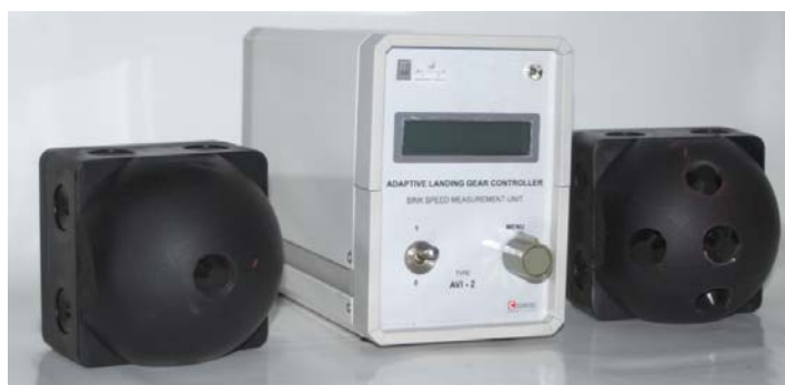
Rys.5.32. Widok ogólny kontrolera wraz z nadawczą i odbiorczą głowicą ultradźwiękową
