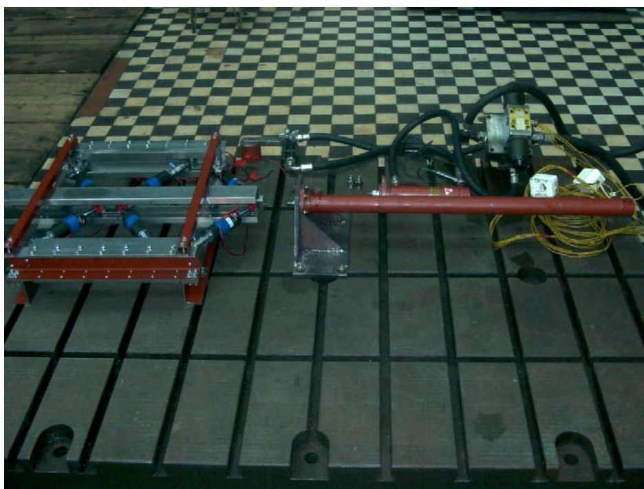
Rys. 5.7. Widok siłownika hydraulicznego wraz z modelem struktury MFM
