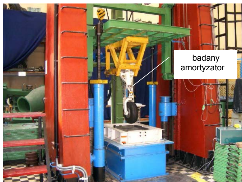
Rys.5.29. Widok ogólny stanowiska udarowego w Instytucie Lotnictwa podczas badań amortyzatora adaptacyjnego
