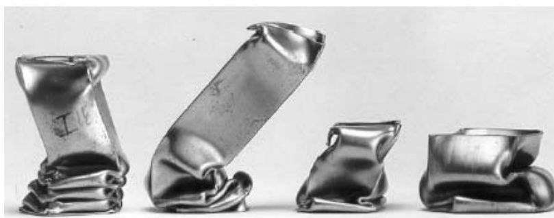
Rys. 1.10. Widok cienkościennego absorbera energii po zakończeniu niestabilnego procesu dyssypacji [3]
