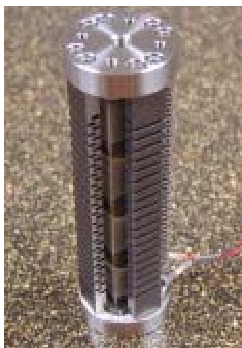
Rys.5.31. Widok ogólny aktywatora piezoelektrycznego PPA80XL użytego w adaptacyjnym amortyzatorze podwozia lotniczego
