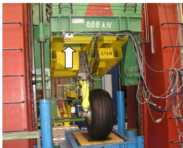
Rys.5.34. Widok ogólny stanowiska doświadczalnego w Instytucie Lotnictwa w Warszawie z podwoziem samolotu m-28 Skytruck. Strzałka wskazuje położenie głowicy ultradźwiękowej
