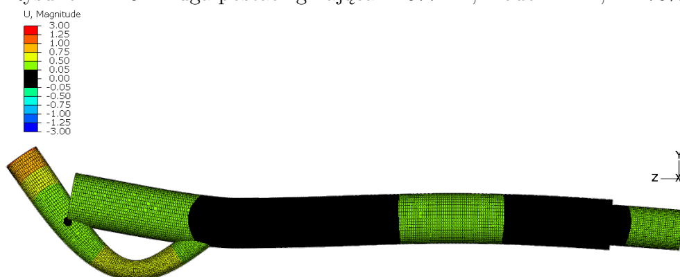
Rysunek A.10: Druga postać zginająca f=677 Hz, model APM, D=75\%
