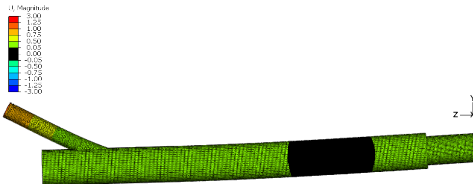
Rysunek A.9: Pierwsza postać zginająca f=249 Hz, model APM, D=75\%
