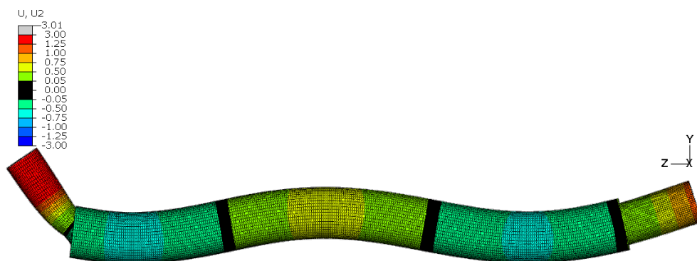
Rysunek A.3: Trzecia postać zginająca f=2282 Hz, model APM, D=0\%
