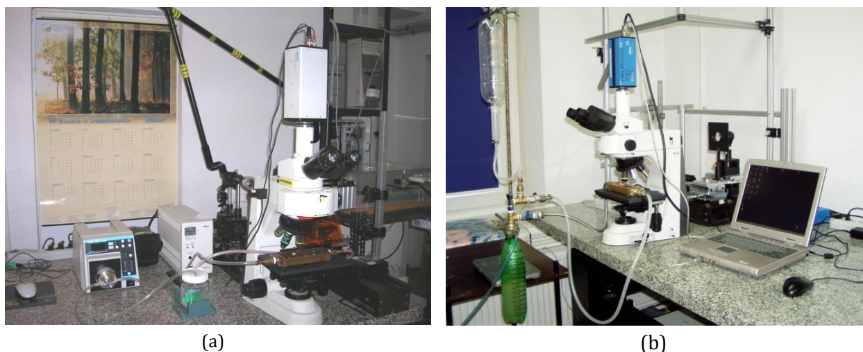
Rys. 4.4. Stanowisko pomiarowe techniką \mu\text{PIV} : a – układ z wymuszaniem przepływu za pomocą pompy zębatej, b – układ z wymuszaniem przepływu przez specjalnie zbudowany układ ciśnieniowy.
