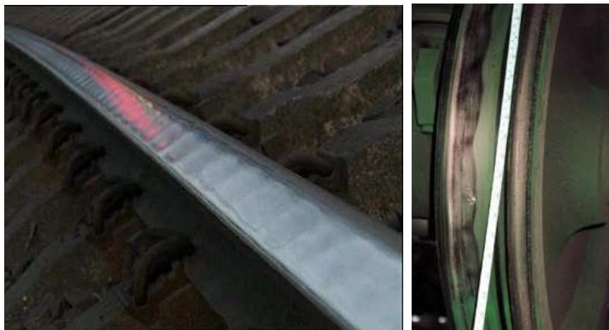
Rysunek 1.1: Widok korugacji na szynie i kole kolejowym.
