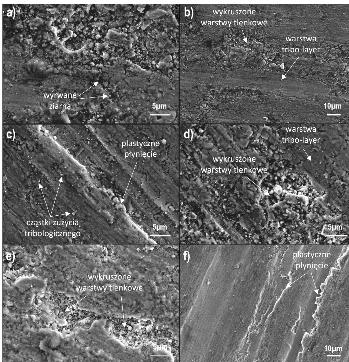
Rys. 74. Zdjęcia powierzchni zużycia tribologicznego powstałego w wyniku przeprowadzenia testów ball-on-flat: a), b) kompozyt infiltrowany utworzony metodą prasowania w stanie ciekłym; c), d) kompozyt utworzony metodą spiekania pod ciśnieniem; e), f) stop aluminium AlSi12 (EN AC – 44200).
