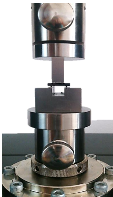
Rys. 25. Układ próbka – podpory w próbie czteropunktowego zginania na maszynie Zwick/Roell ProLine Z050.
