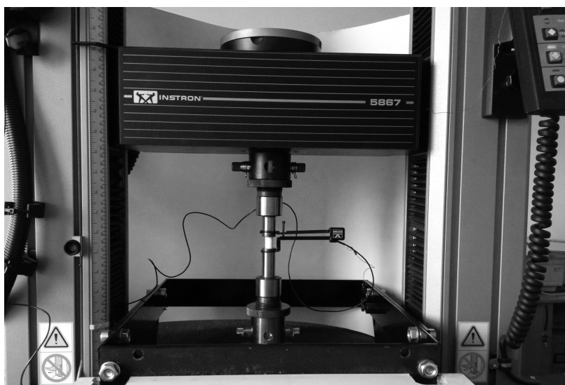
Rys. 5.1: Stanowisko do badań eksperymentalnych wytrzymałości na ściskanie pianek korundowych.
