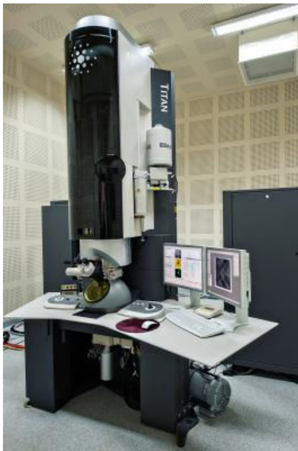
Rys. 35. Mikroskop skaningowo-transmisyjny wykorzystany w badaniach wydzielen struktur dyslokacyjnej i domenowej
