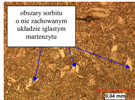
Rys. 101b. Stal 40HNMA z płaskownika przed symulowanymi obciążeniami, stan trawiony, światło konwencjonalne, pow. 500\times
