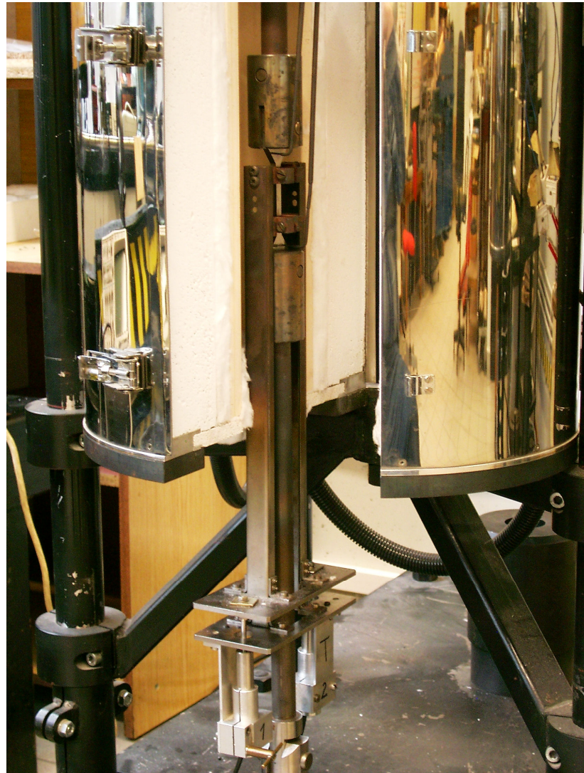
Rys. 29b. Zdjęcie próbki oraz zamocowanego na niej układu ekstensometrycznego
