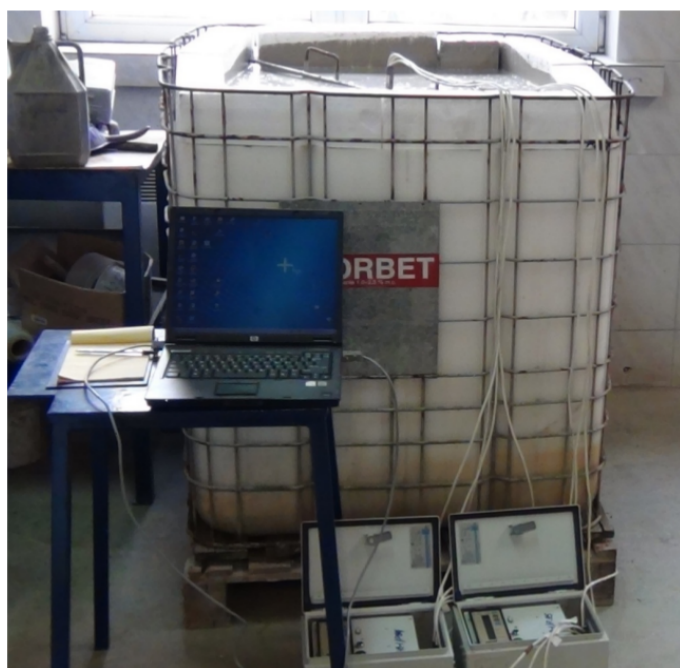
Rysunek 5.10: Forma pomiarowa 3D oraz system akwizycji danych
