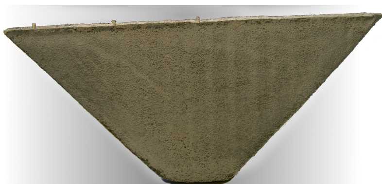
Rysunek 5.5: Zdjęcie trapezowej próbki betonu stwardniałego w formie dwuwymiarowej po rozformowaniu
