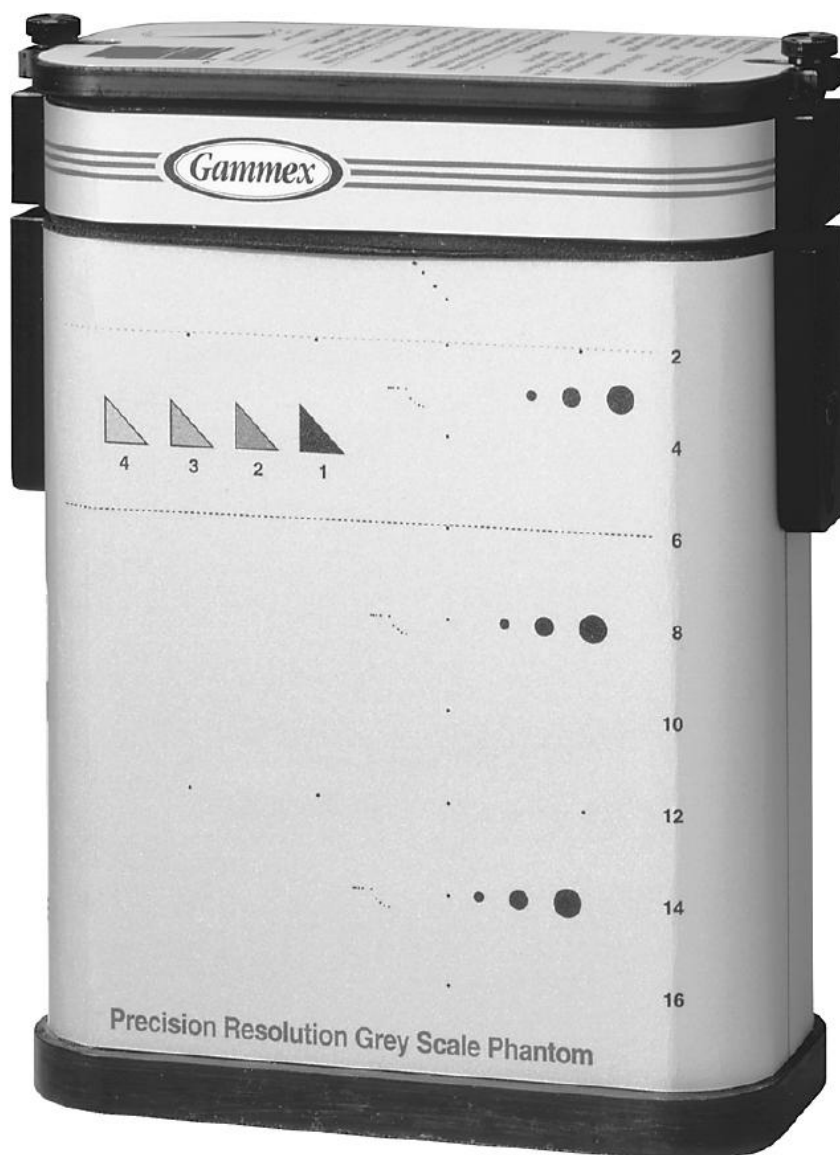
Rysunek A.5: Wzorzec tkankowy Gammex, model 405GSX LE. Zdjęcie pobrane ze strony producenta.
