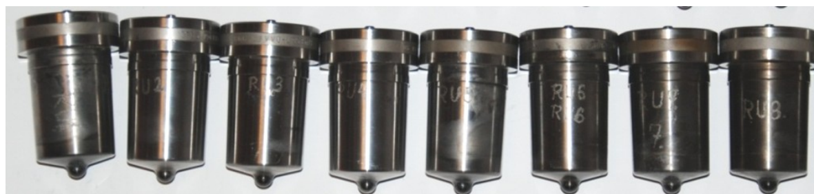
Rys. 23. Partia badanych rozpylaczy: górny rząd – fabrycznie nowe rozpylacze, dolny rząd – rozpylacze zużyte
