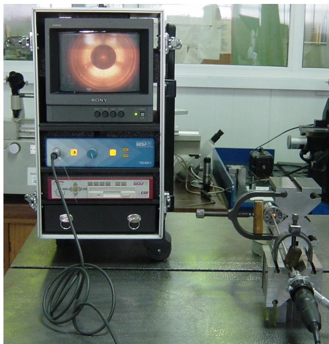
Rys. 33. Badanie gniazd stożkowych korpusów rozpylaczy paliwa za pomocą endoskopu
