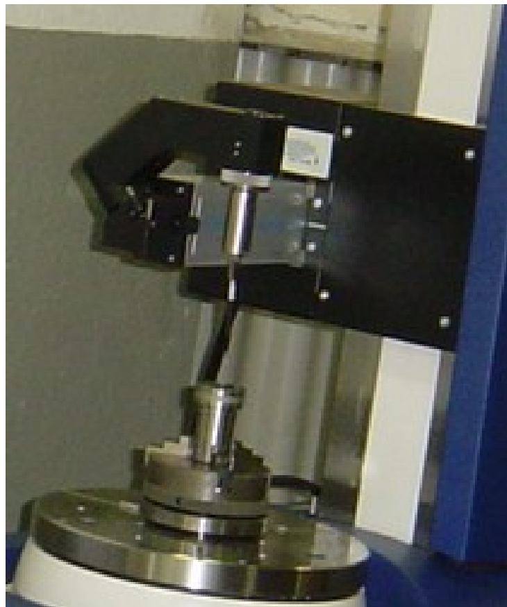
Rys. 19. Pomiary korpusu rozpylacza na maszynie pomiarowej Talyrod 290
