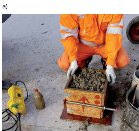
Fot. 4. Ilustracja sposobu oznaczania stabilności krawędzi uformowanej warstwy i podatności mieszanki betonowej na wibracje: a) metoda „box test”, b) metoda VKelly
