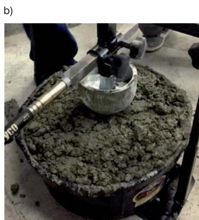
Fot. 4. Ilustracja sposobu oznaczania stabilności krawędzi uformowanej warstwy i podatności mieszanki betonowej na wibracje: a) metoda „box test”, b) metoda VKelly
