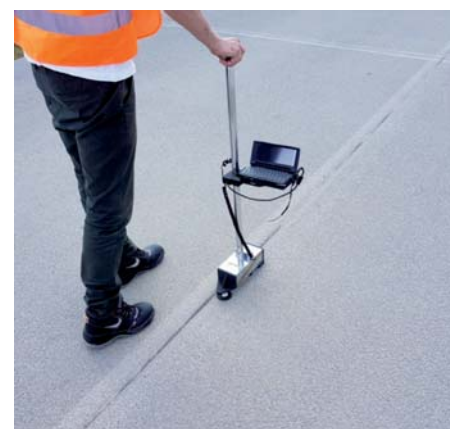
Fot. 6. Pomiar równości podłużnej nawierzchni za pomocą urządzenia Dipstick (laboratorium GDDKiA O/Białystok)
