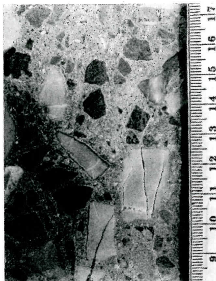
Rys. 3. Przekrój odwiertu betonowego z widocznymi spękaniami ziaren kruszywa [4].
