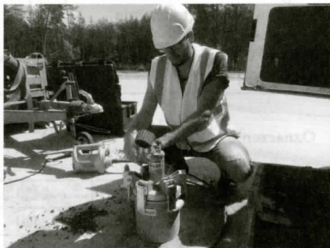
Fot. 1. Widok polowego stanowiska badawczego do wyznaczenia charakterystyki napowietrzenia mieszanki betonowej na miejscu budowy drogi ekspresowej a) zagęszczanie mieszanki, b) pomiar aparatem SAM
