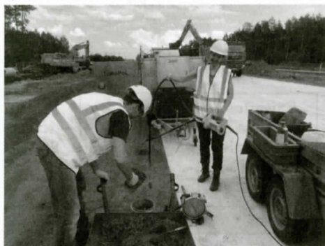
Fot. 1. Widok polowego stanowiska badawczego do wyznaczenia charakterystyki napowietrzenia mieszanki betonowej na miejscu budowy drogi ekspresowej a) zagęszczanie mieszanki, b) pomiar aparatem SAM
