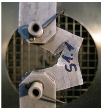
Rys. 3.19. Rozrywanie próbki w komorze temperaturowej w -10^{\circ}\text{C} , faza rozwoju pęknięcia dominującego
