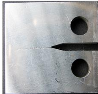
Rys. 3.9. Próbka kompaktowa z wypropagowaną szczeliną zmęczeniową o konkretnie zadanej długości
