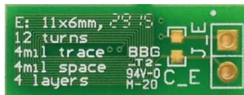
Rys. 3. Schemat uzwojeń i zdjęcie płytki wielowarstwowej obwodu drukowanego [3]
