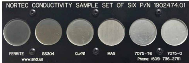
Rys. 13. Zestaw sześciu wzorców dla testów konduktywności
