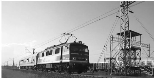
Rys. 3 – Pojazd badawczy- lokomotywa i pomiarowy wagon
