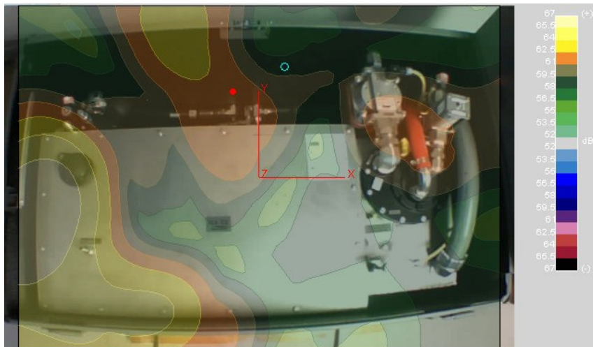
Rys.7 Rozkład poziomy ciśnienia akustycznego w 1/3 oktawowym paśmie częstotliwości o częstotliwości środkowej 2kHz
