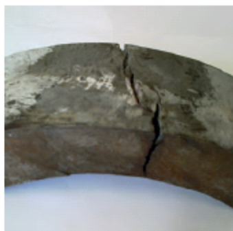
Rys. 1. Uszkodzenia materiału powstałe w wyniku pełzania
