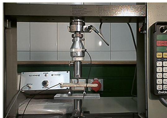
Rys. 2. Maszyna wytrzymałościowa ZWICK wyposażona w kontaktowy adapter do rejestracji fal sprężystych
