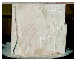
Rys. 14.6. Zniszczenie próbki skały w próbie jednoosiowego ściskania.
