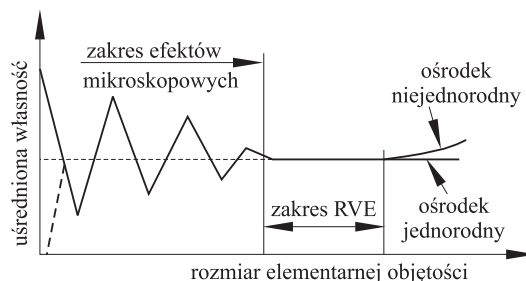
Rys. 8.3. Określenie rozmiaru reprezentatywnego elementu objętościowego.
