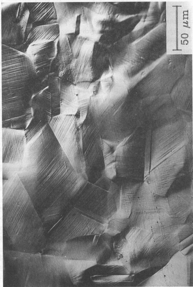
Rys. 29. Mezostruktura powierzchni próbki o odkształceniu \epsilon = 0.045 , odpowiadająca maksimum zdolności magazynowania energii. Widoczne są mikropasma ścinania przechodzące przez kilka ziaren.
