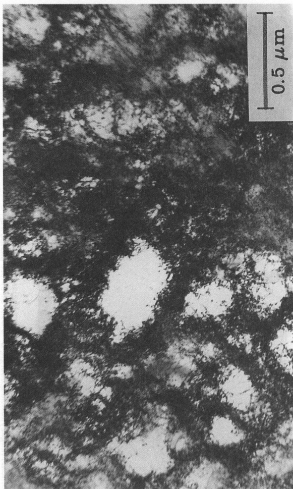
Rys. 25a. Komórkowa struktura dyslokacyjna w próbkach drobnoziarnistych, \epsilon = 0.25 .
