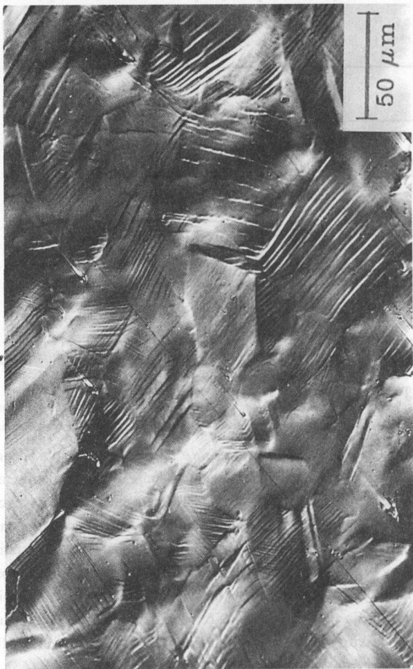
Rys. 31. Mezoszuktura powierzchni próbki o odkształceniu, \epsilon = 0,20 . Widoczny jest front Ludersa.
