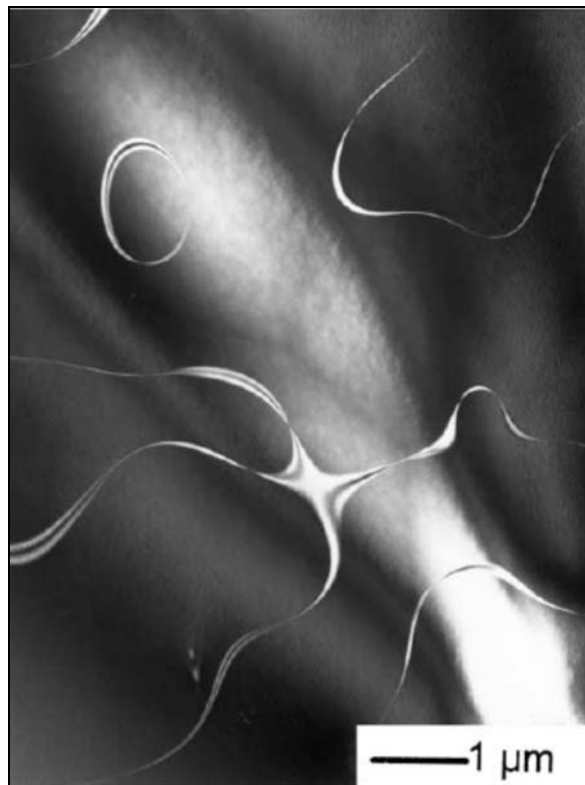
Rys. 9. Granice domen antyfazowych [65]. Stop Ti 25Al 15V [% at.].
