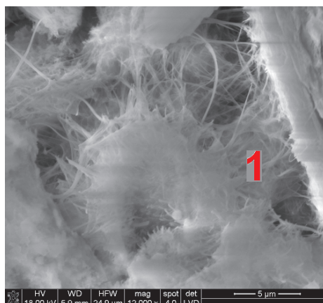
Rys. 11. Obraz mikrostruktury zaprawy z cementem żużlowo-wapiennym po 240 dniach oddziaływania \text{Na}_2\text{SO}_4 (1 – drobne igielki etryngitu)
