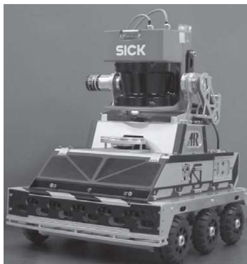
Rys. 1. Zdjęcia robota „Elektron” z laserem 3D oraz kamerą dookólną na górze
