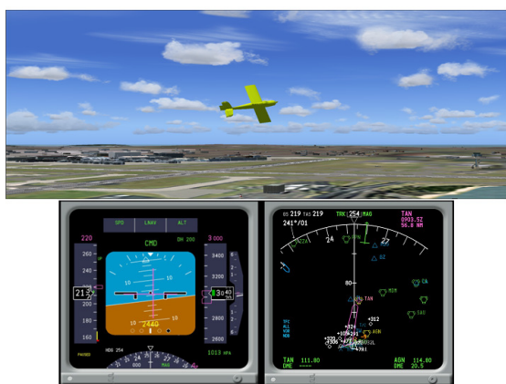
Rys. 6. Model samolotu i środowiska ruchu symulatora oraz formy graficzne parametrów pilotażowych i nawigacyjnych prezentowanych na wskaźnikach PFD i ND
