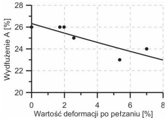
Rys. 11. Zmiany wydłużenia rozciąganych próbek w funkcji odkształcenia pełzania
